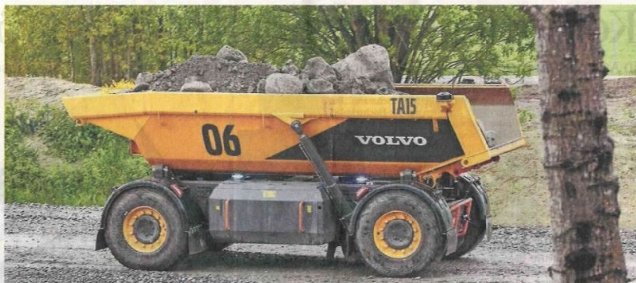
Autonom und elektrisch soll der Transport in den Sandwerken funktionieren, dafür kommen unter anderem Volvo TA15 zum Einsatz. Die Energie dafür soll aus erneuerbaren Quellen kommen. Wie Prozessketten aussehen und organisiert werden können, soll im Projekt „ELMAR“ erforscht werden. FOTO: VOLVO/CEAB VOLVO 2022
